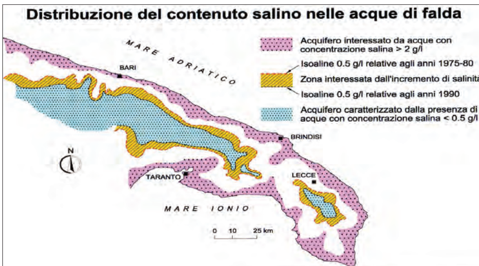
Figura 7 - Intrusione continentale delle acque marine (da Cotecchia V. et al., 1993)
