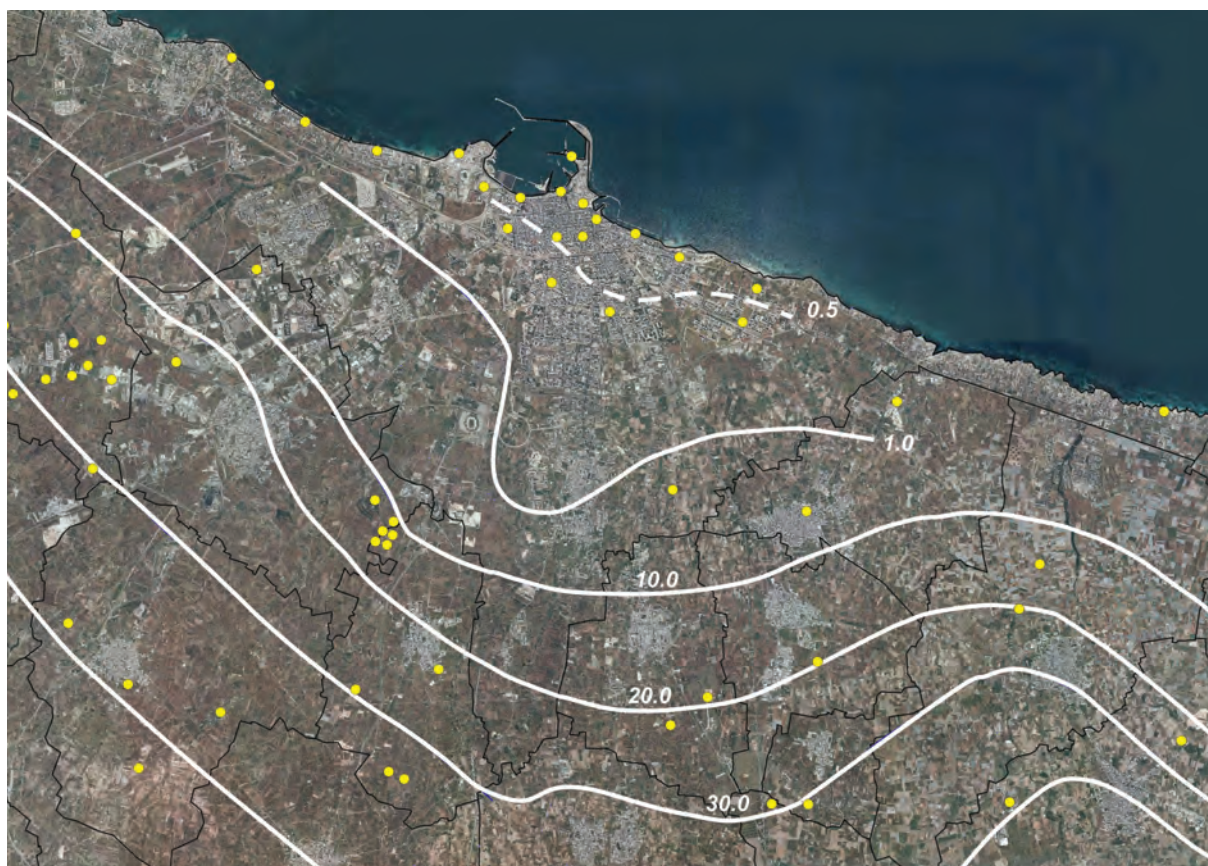
Figura 11 - Piezometrica della falda idrica nella città di Bari. Molti vani interrati del quartiere Murattiano, costruito a partire dal 1850, sono invasi da acque di falda sostenute da un mare più alto. I sistemi di aggottamento automatico e molti nuovi impianti di condizionamento che attingono alla falda come sorgente a temperatura inferiore sono responsabili dell'evidente cono di depressione in corrispondenza della città
