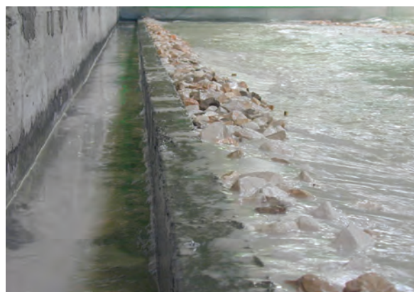
Figura 12 - Canaletta per la valutazione del fenomeno dell'overtopping (configurazione attuale delle opere)
