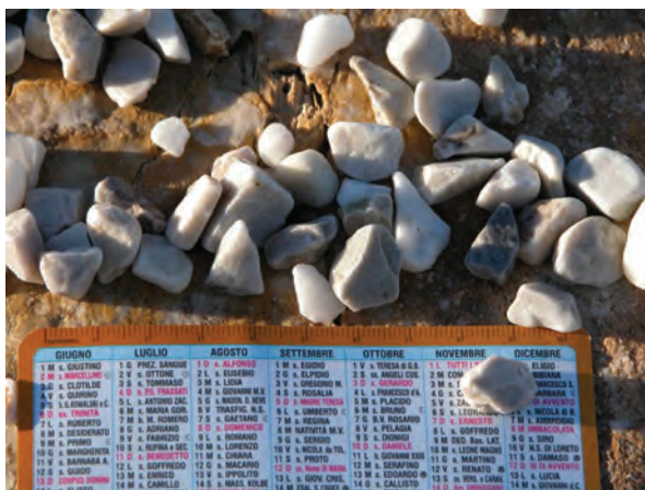
Figura 15 - Dimensione della ghiaia utilizzata per il primo ripascimento
