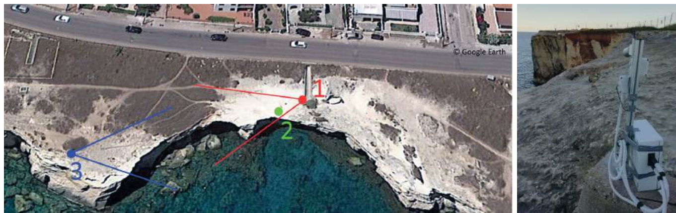
Figura 15 - Esempio di monitoraggio in continuo di un tratto di falesia mediante fotocamera a base fissa. (da Guenzi et al. 2022).
